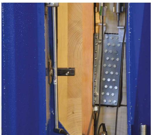
Dati sperimentali sulla prestazione statica di una connessione legno-acciaio con ALADIN interposto
