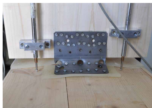
Prova monotona a trazione ( F_1 ) su NINO15080 in configurazione legno-legno.
