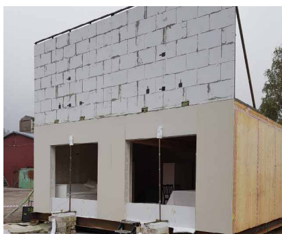
Foto del compartimento una vez finalizado el montaje, antes de empezar la prueba
