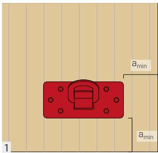
Die Anleitung genau lesen und die Hinweise beachten. Bei der Positionierung der Platte auf dem zu transportierenden Holzelement sind die empfohlenen Mindestabstände einzuhalten.
