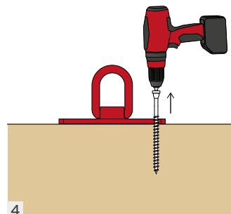
Länge und Anzahl der Schrauben hängen von der Anwendung und dem Gewicht des zu bewegenden Elements ab. Bei der Verschraubung sind die in der jeweiligen Montageanleitung angegebenen Anzugsmomente zu beachten.
