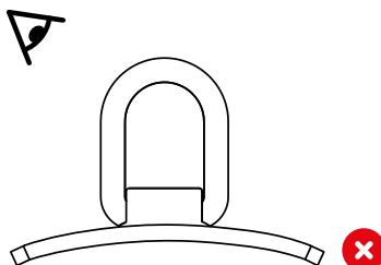
Contrôle visuel avant chaque utilisation. En cas de défaut, le produit ne doit plus être utilisé.
