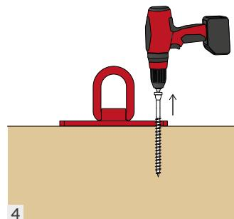
La longueur et la quantité des vis dépendent de l'application et du poids de l'élément à déplacer. Il est conseillé de les visser en respectant les couples de serrage indiqués dans les instructions d'installation relatives.
