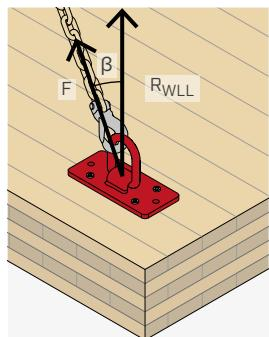
$\beta$  = angle de levage (angle entre vertical et chaîne)
