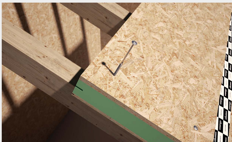
Fixation de panneaux SIP avec des vis TBS de 8 mm de diamètre.
