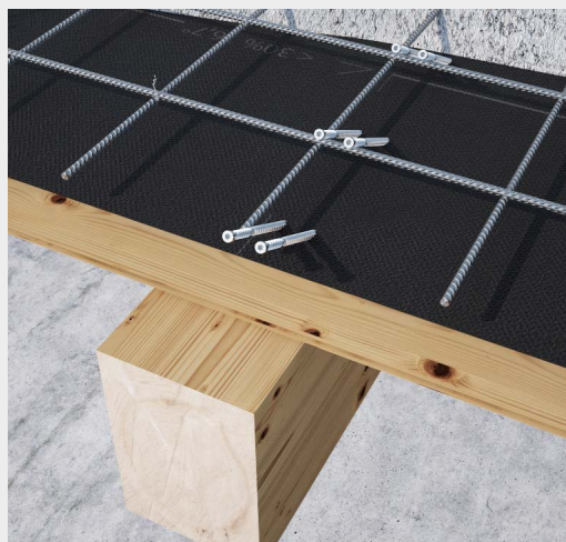
^ Puu-betoniyhdistelattia CLT-levyllä 30° liittimillä asennettuna kahteen riviin.
