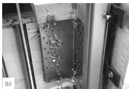
Uzorci na kraju cikličkog ispitivanja: vuča (a), smicanje (b) i 45^\circ (c) (djelomično pričvršćivanje).
