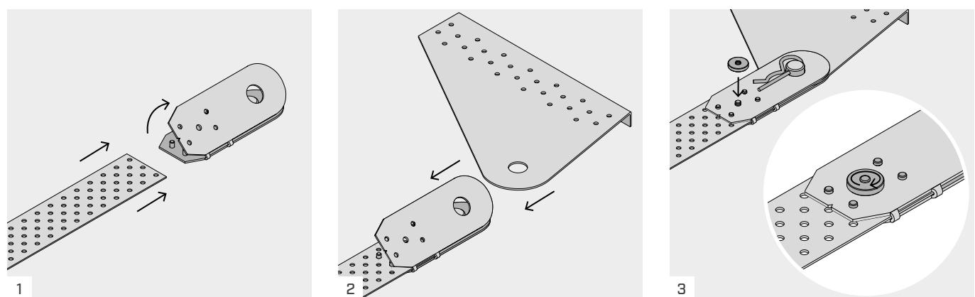
Die Endbefestigung öffnen und das Windrispenband einsetzen.
