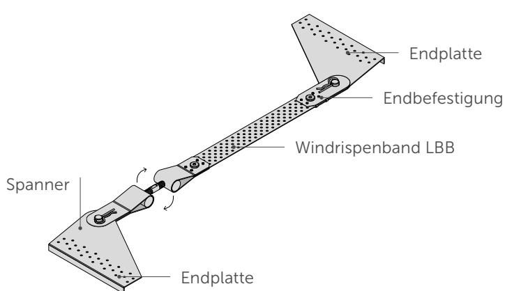
Mithilfe des Spanners die Länge des Verstrebungssystems einstellen.
