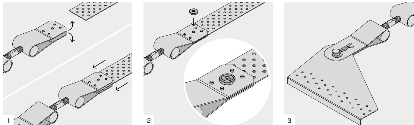
Den Spanner öffnen und das Windrispenband einsetzen.
