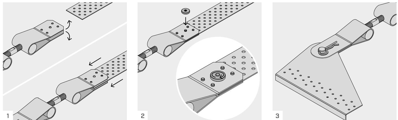
Abrir el tensor e insertar el fleje perforado.
