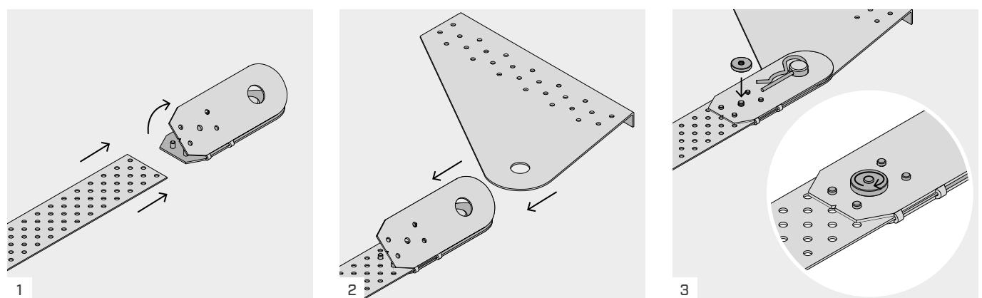
Abrir el terminal e insertar el fleje perforado.
