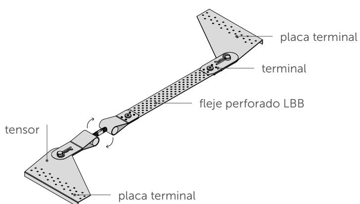
Actuar sobre el tensor para regular la longitud del sistema de arriostramiento.
