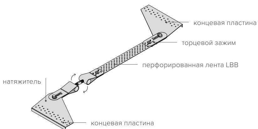
Воздействуйте на натяжитель, чтобы отрегулировать длину системы связей жесткости.
