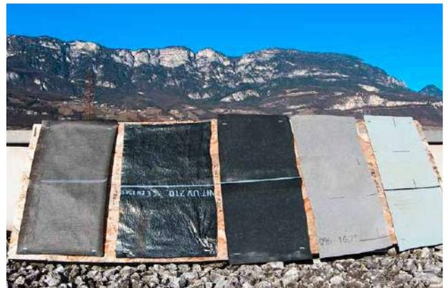
L'exposition en milieu extérieur permet de tester la résistance aux agents atmosphériques, sous l'effet synergique des rayons UV, de l'humidité, de la chaleur et de la pluie.
