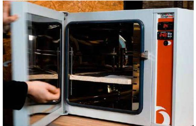
Par le test Martindale, nous étudions la résistance à l'usure, à la rupture et le boulochage de nos membranes. Avec les fours et les chambres à basse température, nous testons le comportement de nos produits lorsqu'ils sont exposés à des températures extrêmes.
