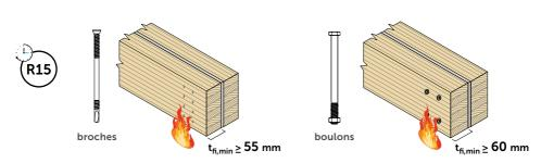
La résistance au feu peut être mise en œuvre jusqu'à 120 minutes en augmentant la taille des éléments bois  $(t_{\rm f})$  et les distances aux bords des éléments métalliques.
