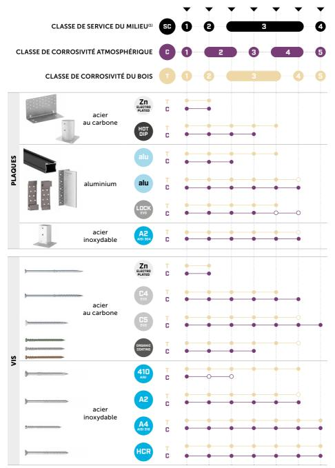
La combinaison entre différents métaux en milieux externes nécessite également l'évaluation du risque de corrosion par couplage galvanique.
