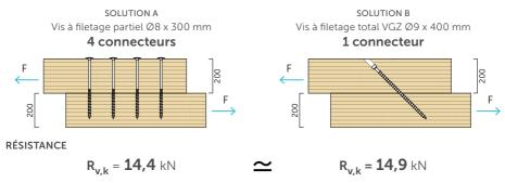
4 connecteurs à filetage partiel sont nécessaires pour égaler la résistance au glissement d'1 vis à filetage total inclinée à 45°.
