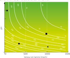
Le facteur le plus important à considérer dans le processus corrosif est la classe de corrosivité du bois (T) liée au pH et à l'humidité du bois.
