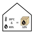
Un élément en bois placé dans un environnement avec une humidité relative de 65 % et une température de 20 ° C aura. en équilibre, une valeur d'humidité correspondante de 12 %.
