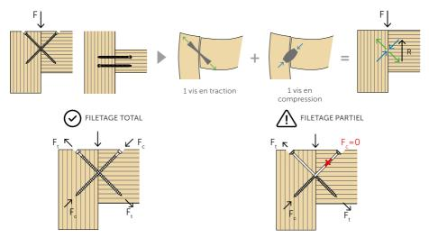
La partie filetée garantit d'excellentes performances tant en traction qu'en compression et permet d'atteindre une résistance globale élevée. La tête de la vis ne résiste pas à la compression (elle se détache du bois) et offre une résistance limitée à la traction (pénétration < extraction du filet).
