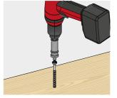
Sélectionner la taille et le type d'embout approprié. Le support pour vis CATCH ou CATCHL de Rothoblaas peut être pouvant créer des états de surcon- utilisé pour s'assurer que l'embout reste dans la fente de la tête de la vis pendant l'installation.
