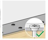
Garantir un contact complet entre la surface de la tête de la vis et l'élément métallique.
