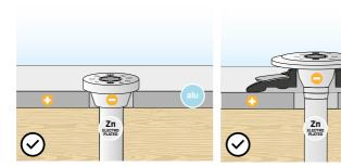
WBAZ RONDELLE INOXYDABLE AVEC JOINT D'ÉTANCHÉITÉ
