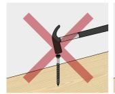
Ne pas frapper sur les vis pour insérer la En général, il est conseillé d'insérer le pointe dans le bois.
