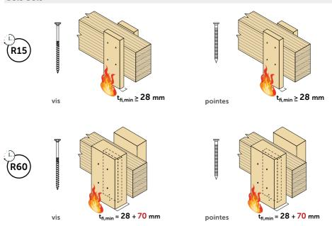
Pour les assemblages avec des vis ou des pointes, il est possible d'augmenter la résistance au feu  $(R_{td})$  jusqu'à 60 minutes en augmentant la taille des éléments en bois.
