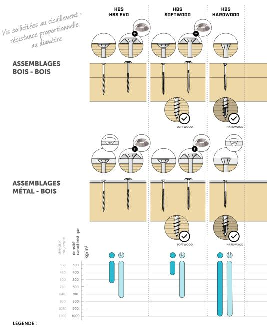
insertion sans pré-perçage (V) insertion avec pré-perçage application non conseillée mais possible en prenant des mesures spécifiques
