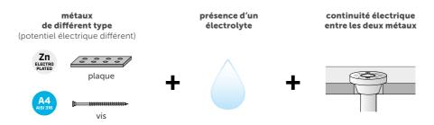
Plus les métaux sont dissemblables (majeure différence de potentiel), plus le risque de corrosion est grand. Le potentiel de corrosion galvanique entre les métaux est dicté par la distance qui les sépare sur la "série galvanique des métaux". Approximativement, une différence de potentiel supérieure à 0,4-0,5 V pourrait être considérée comme significative/critique.
