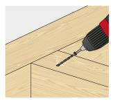
Trou pilote conseillé pour garantir la Respecter l'angle d'insertion. bonne direction d'installation.
