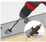
Trou pilote conseillé pour garantir la Utilisation du gabarit JIG VGU couplé avec la rondelle VGU conseillée.
