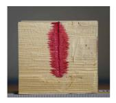
La partie du bois concernée par l'insertion de la vis est plus importante si aucun pré-perçage n'est effectué.
