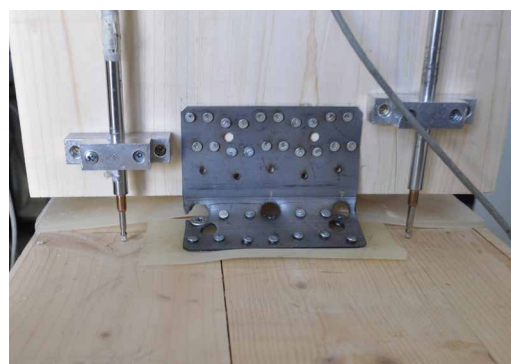
Essai de traction monotone ( F_1 ) sur NINO15080 en configuration bois-bois.
