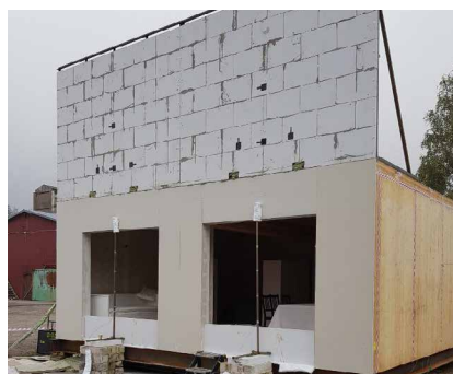
Photo du compartiment à la fin du montage, avant de commencer le test
