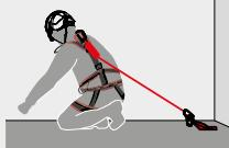
如果无法消除坠落风险，请使用适当的安全防护系统，以降低坠落风险，采用限制或坠落防护系统。
