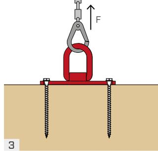
3 Mit dem Kranhaken anschließen und das Element vorsichtig anheben. Auf die zulässigen Hubwinkel und -richtungen sowie die entsprechenden maximalen Traglasten achten.
