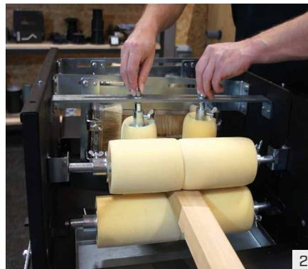
Schwämme an die Dimensionen des Werkstücks anpassen und mit den Schrauben fixieren.
