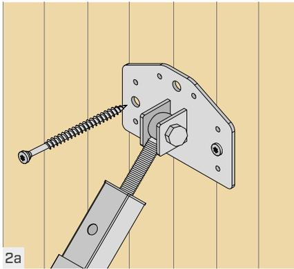
Befestigung der GIRAFFE-Platte an der Wand mit HBS PLATE Schrauben.
