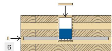
Nach dem Hebevorgang können sowohl das Sackloch als auch das seitliche Loch mit TAPS verschlossen werden
