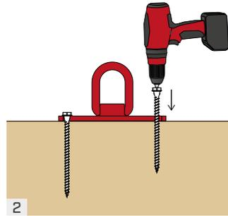
2 Länge und Anzahl der Schrauben hängen von der Anwendung und dem Gewicht des Elements ab. Auf den korrekten Anzug achten und die in der jeweiligen Montageanleitung angegebenen Momente berücksichtigen.
