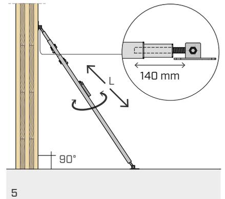
Die Wand durch Längeneinstellung von GIRAFFE mittels Revolvergriff präzise positionieren.
