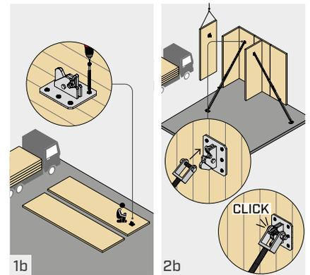
1b. Die CLICK-Platte muss vor der Montage im oberen Drittel der Wand installiert werden.
