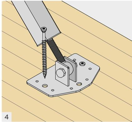
Befestigung der GIRAFFE-Platte an der Holzdecke mit HBS PLATE Schrauben und an der Betondecke mit SKR-Schraubanker.
