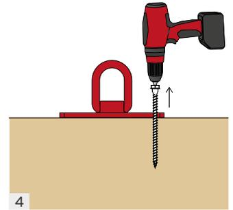
4 Die Schrauben nach dem Heben entfernen und entsorgen. Außer VGS PL, die unter bestimmten Bedingungen für den Transport wiederverwendet werden kann, können sie nur für einen Transportvorgang verwendet werden. Die Anweisungen beachten.
