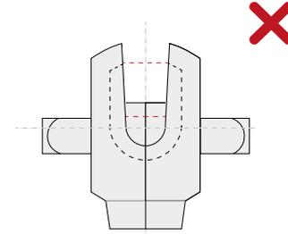
Ansicht der Zugkugel des Ankers von unten. Der Abstand zwischen den Flanschen an der Öffnung der Öse ist breiter als der am Verschluss der Öse.
