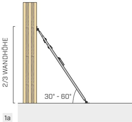
GIRAFFE an der Wand positionieren und passend in der Länge verstellen. Die Halterung muss im oberen Drittel der Wand angebracht werden. Der Winkel von GIRAFFE sollte zwischen 30° und 60° liegen.
