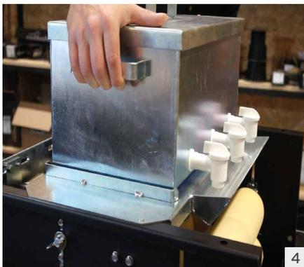
4 Colocar el depósito de color y asegurarse de que las boquillas estén cerradas. Enganchar el cubo de recogida debajo del depósito.
