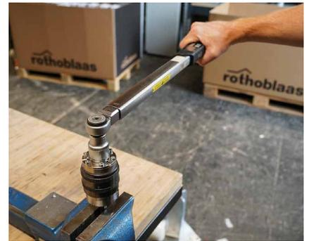
Realizar un control inicial del par con una llave dinamométrica.
