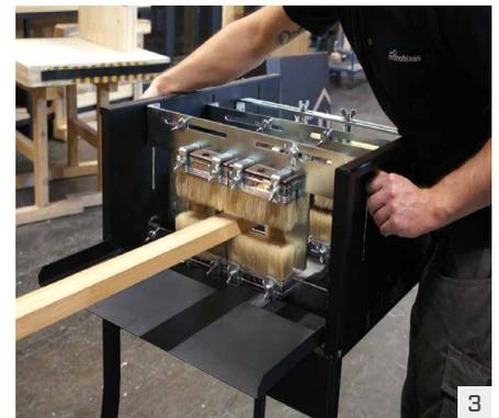
3 Regular los cepillos en función del elemento y fijarlos apretando los tornillos.
