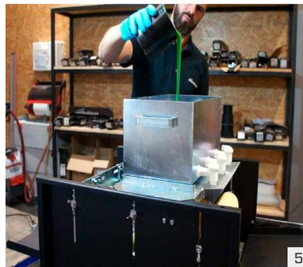
5 Introducir la pintura o el impregnante. Si es necesario, mezclarlo hasta obtener una consistencia homogénea.
