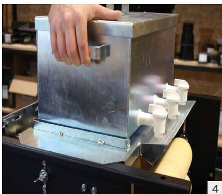
4 Positionner le réservoir des couleurs et s'assurer que les buses soient fermées. Accrocher le bac de récolte sous le réservoir.
