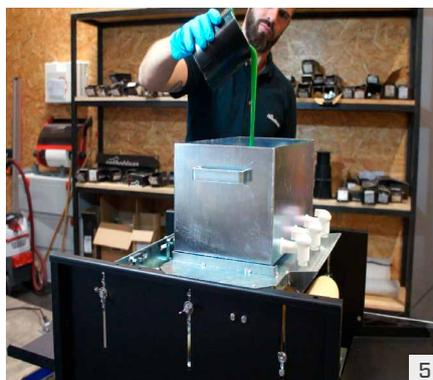
5 Verser la peinture ou le produit d'imprégnation. Si nécessaire, mélanger jusqu'à obtenir une consistance homogène.
